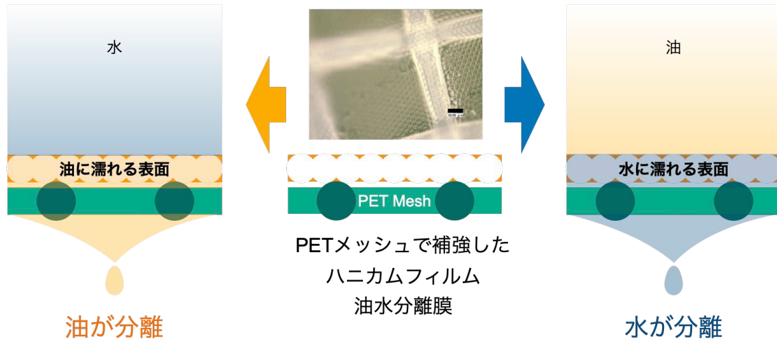
図 1. 作製した油水分離膜の顕微鏡写真と油水分離のしくみ
