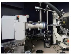
全自动水平型多目的X線回折装置(株)リガク製 Smart Lab 3G
