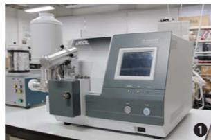
電界放出型の走査電子顕微鏡と試料作製に有用なクロスセクションポリッシャです。オプションにエネルギー分散型X線分析装置(EDS)、結晶方位解析装置(EPDM)を備えており、トランസファーべッセルも用意しています。
