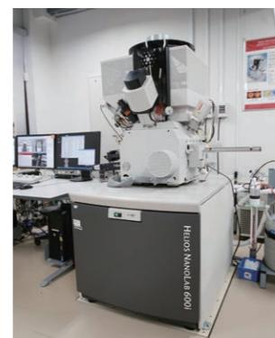
集束Gaイオンビームにより試料をナノスケールで精密に加工する装置で、加工時の熱影響を低減するためのクライオシステムを備えています。更に加工時に取得した1枚ずつの連続した2Dデータを3D化するソフトウェアも備えています。
