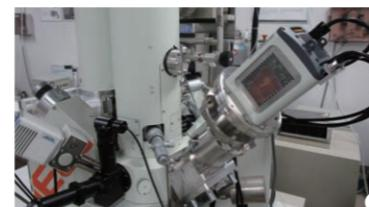
電界放出型の電子プローブマイクロアナライザで、波長分散型X線分光器(WDS)で取得したデータから元素濃度や化学組成をマッピングするソフトウェアを装備しています。更に本学内教授らが開発した軟X線分光器(SXES)を備えており、Liなどの軽元素の解析も可能です。
